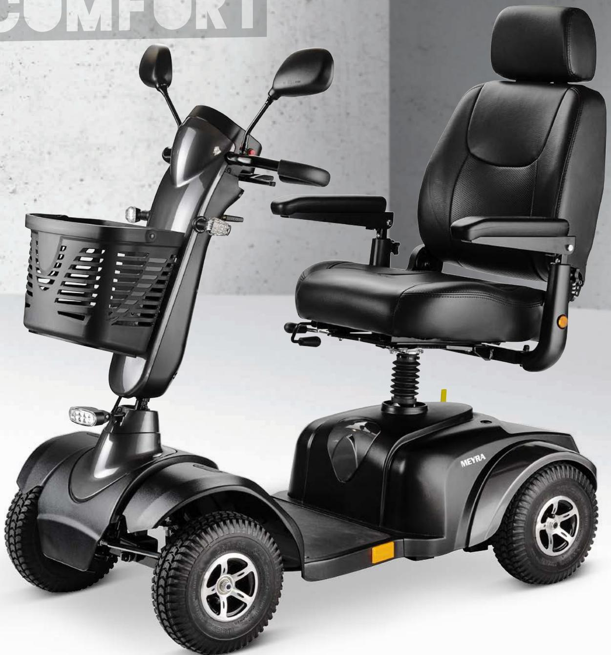
**Der CL510 zeichnet sich durch seine außergewöhnliche Steigfähigkeit aus.** Diese resultiert aus seinem starken 400 Watt (Spitzenleistung 1.600 Watt) Motor, gepaart mit einer 120 Ampere Penny & Giles Elektronik. Sein gefedertes Sitzsystem mit stufenlos einstellbarem Rückenwinkel lässt keine Wünsche offen. Dank der kompakten Bauweise ist eine Mitnahme im ÖPNV möglich.
