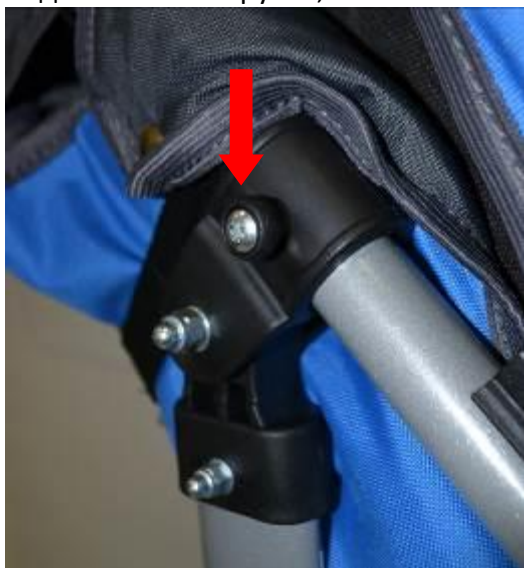
Фото 46А. Монтаж подстаканника
